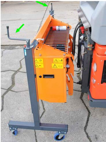
Abb. 2: Höhenanpassung mittels Kurbelstützen
