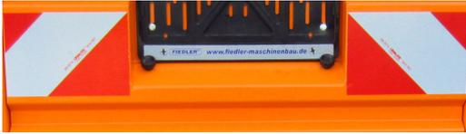
Abb. 17: Abdeckung mit Rändelschrauben
