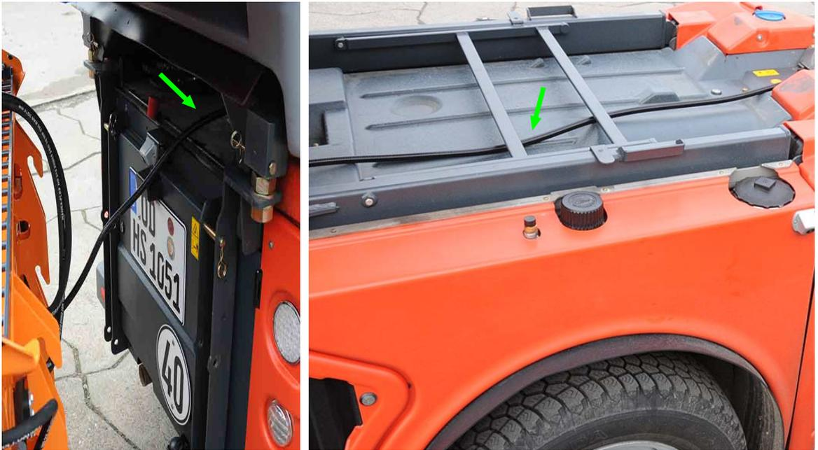
Abb. 3: Kabelverlegung Steuerleitung
